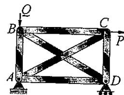
6. 附圖之構架為由柱  $CD$  以滑動面支撐樑  $AB$  而成，柱  $CD$  之長度為  $L$ ，撓曲剛性為  $EI$ ，此構架在點  $B$  受一集中力  $P$ ，則其臨界力  $P_{cr}$  為
